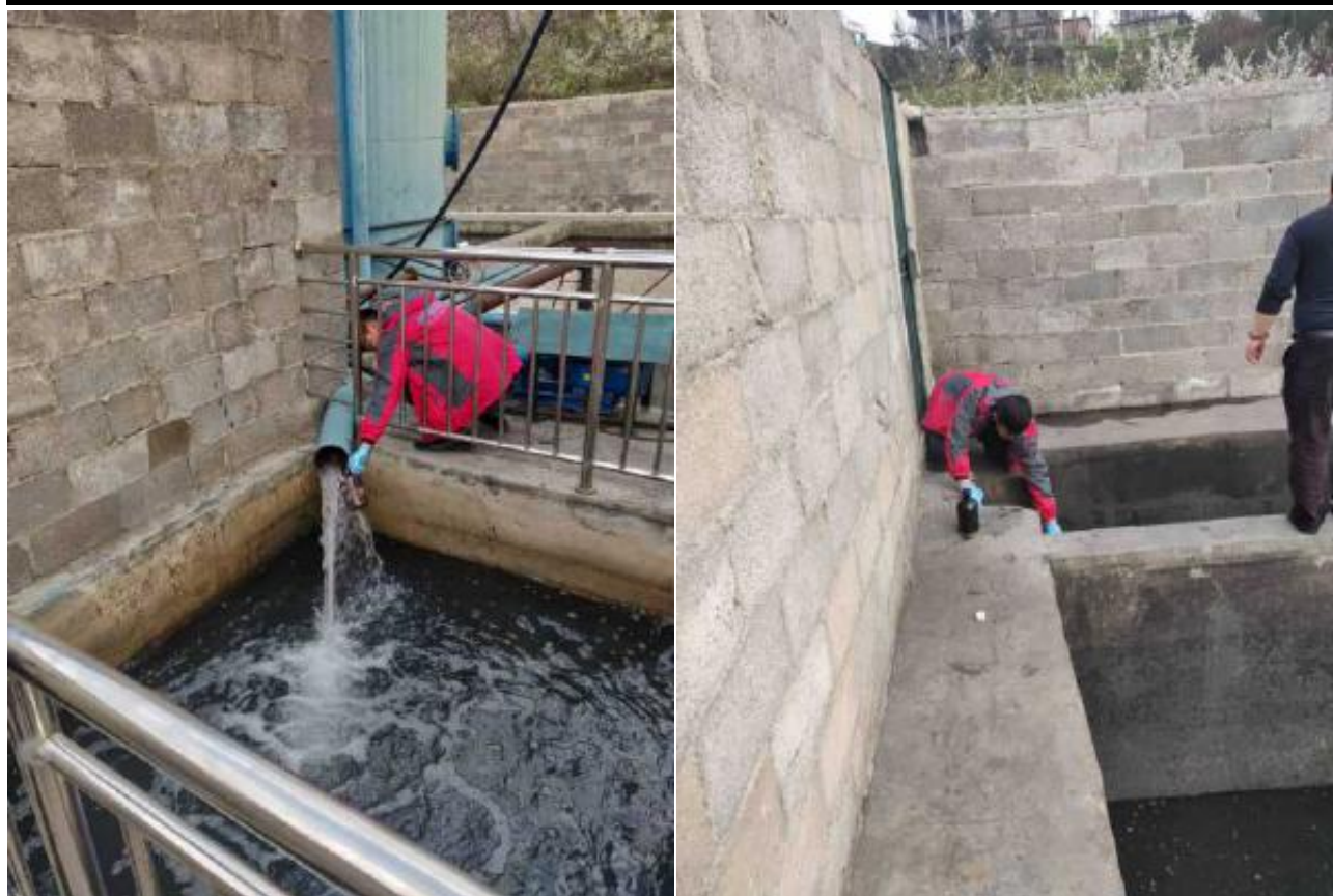
污水处理站采样
